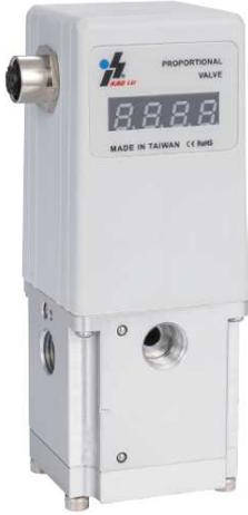
전자식 진공 조절기는 2 개의 솔레노이드 밸브, 1 개의 압력 변환기 및 PID 폐쇄 루프 제어를 수행하는 전자 보드로 구성된 폐쇄 루프 설계입니다. 입력된 전자 신호에 따라 하나의 밸브는 진공 흡입구를 열고 다른 밸브는 진공 차단기 역할을 합니다. 진공 수준을 높이는 동안 흡기 밸브는 내부 피스톤에 작용하여 공기가 빠지도록 합니다. 내부 압력 변환기는 진공 수준을 감지하고 목표 진공 수준에 도달할 때까지 두 밸브의 동작을 차례로 제어하는 전자 보드에 피드백을 제공합니다.
