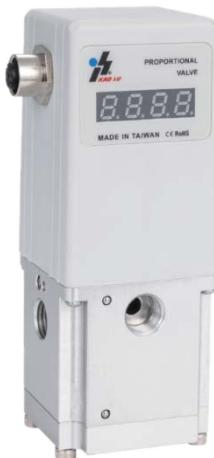
该比例阀为一个闭回路设计，由两个电磁阀、压力传感器以及电子回路控制所组成。根据输入讯号渐大，真空用电磁阀为开启状态，破真空用电磁阀为关闭状态。因此，抽取真空压力时透过真空用电磁阀作用于内部活塞，并致使与活塞连动的排气阀打开，进而将大气转换成负压，并通过压力传感器反馈至控制回路。在此，该比例阀作动过程中会进行修正动作，直到真空压力与输入讯号成比例。
