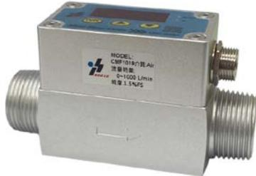
KMF1000 系列数字气体质量流量计采用微机电系统流量感测芯片，适用于各种用途的清洁、相对干燥的小流量气体测量和制程控制，特别的封装技术使得此产品满足不同范围的流量测量，能够保证高灵敏度、高可靠性、高稳定性和低成本。它的原理是基于 MEMS 流量感测单元和高精度数位处理和校准电路。整合  $\Delta-\Sigma$  A/D 转换器以及内部具有校准功能的组合逻辑电路和 MCU 处理器共同确保感测讯号的实时有效撷取，获得准确的流量讯号，并在内部进行相应的补偿算法处理，因此无需进行任何外部校准和补偿即可确保高精度的流量输出。
